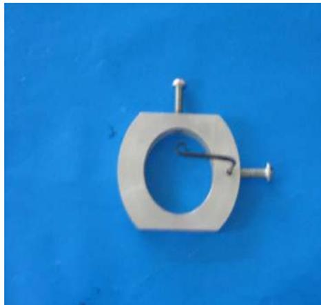
Figura 59. Dispositivo para ajustar al objetivo 10X del microscopio.
