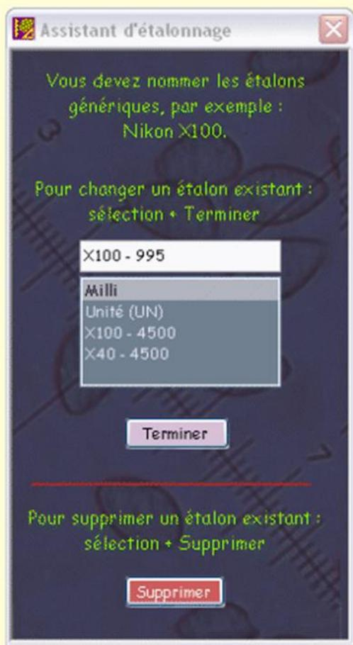
Le bouton "Supprimer" permet d'effacer un étalon sélectionné dans la liste.
