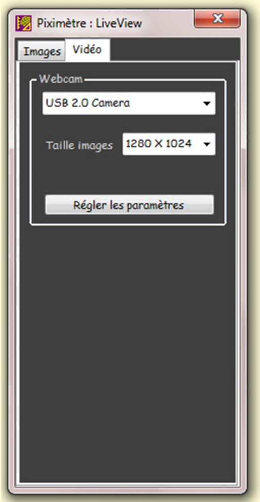
L'onglet « Vidéo », ci-contre, permet de sélectionner la caméra désirée parmi celles qui sont connectées à l'ordinateur et reconnues par l'assistant. Si la caméra n'est pas connectée à cet instant, il suffit de fermer l'assistant, de connecter la caméra et de rouvrir l'assistant.
