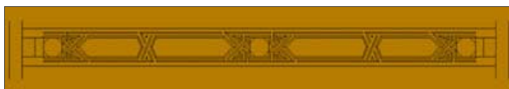
Figura 2: Trazado de lazo en cada pareja de tirantes
